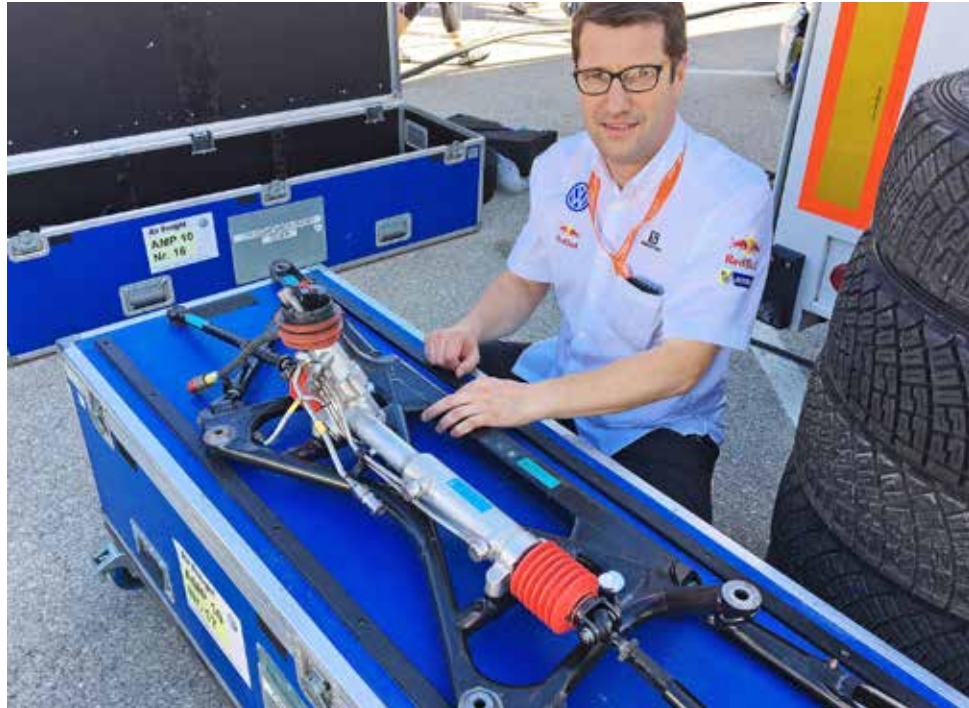
Volkswagen: Technikchef FX Demaison erklärt die Lenkung des VW Polo R WRC
