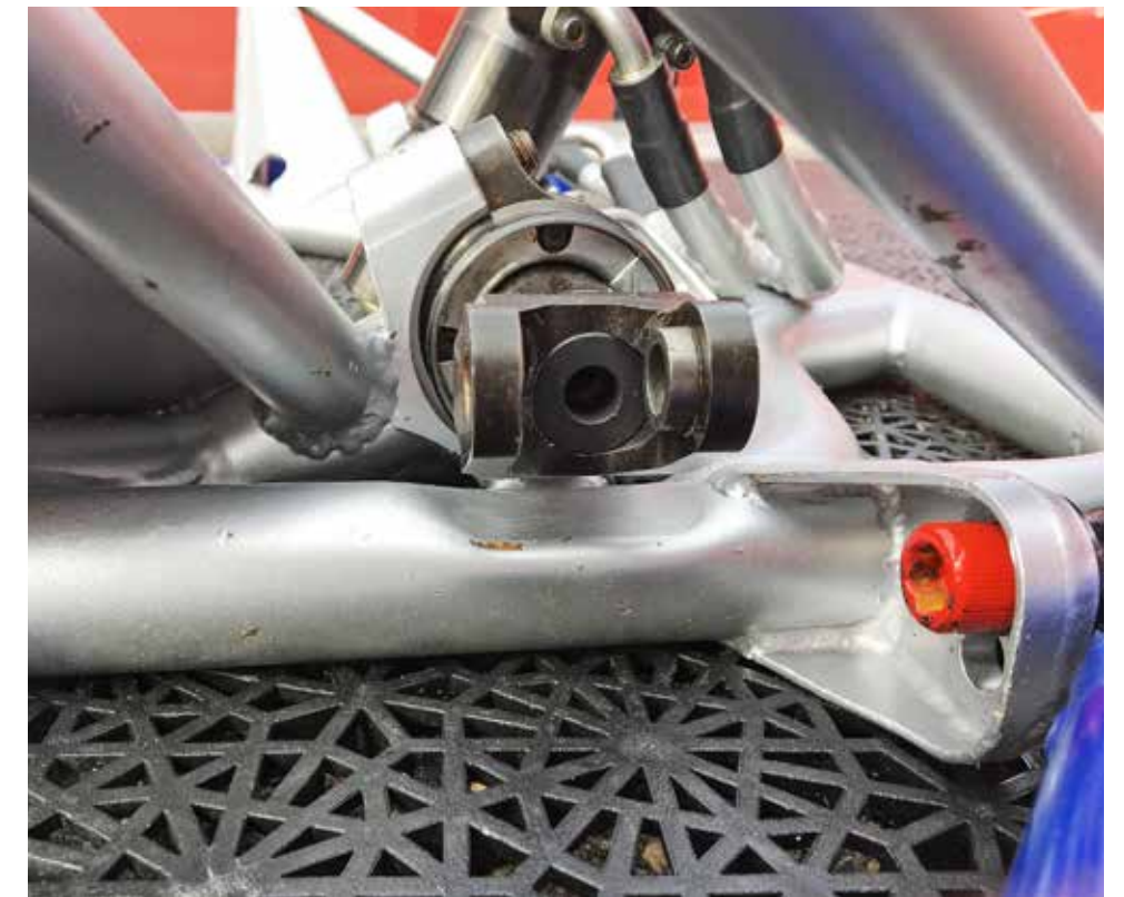
M-Sport: Die Kundensport-Experten bieten mehrere Drehstäben (oben am Lenkgetriebe) und Spurstangenaufnahmen zur individuellen Abstimmung der Fiesta WRC-Lenkung
