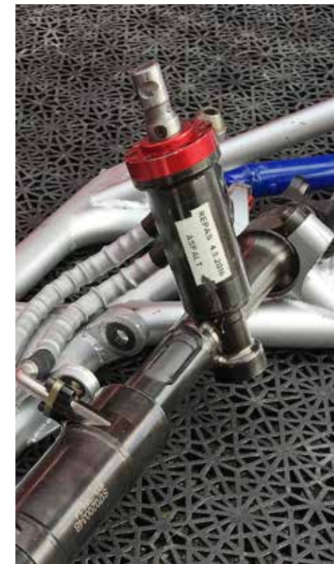
M-Sport: Die Kundensport-Experten bieten mehrere Drehstäben (oben am Lenkgetriebe) und Spurstangenaufnahmen zur individuellen Abstimmung der Fiesta WRC-Lenkung
